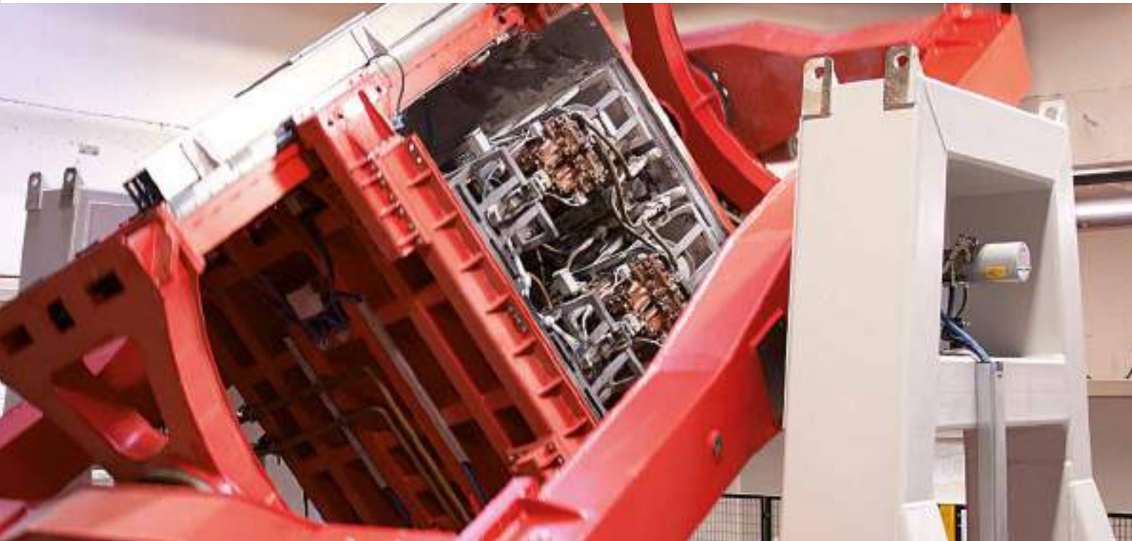
Fig. Maquinaria de molde rotativa en la fábrica 2, Illertissen
