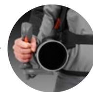
O acelerador está posicionado de modo a neutralizar as forças laterais geradas pelo fluxo de ar e o motor
