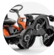
Uma unidade de corte limpa produz sempre ótimos resultados. Nos Riders pode ser levantada com facilidade para simplificar as operações de limpeza e manutenção.
